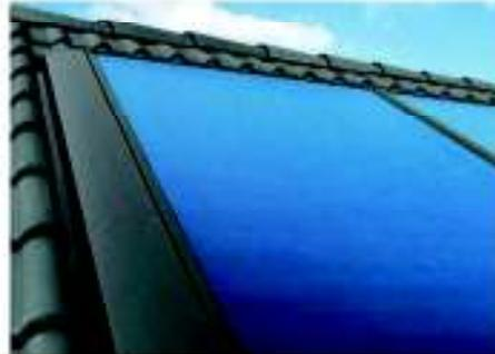
Kolektor płaski Vitosol 200-F posiada mrozoodporne i odporne na grad szkło bezodpryskowe, a także odporne na korozję elementy konstrukcyjne ze stali szlachetnej i aluminium. Na życzenie dostarczany jest we wszystkich kolorach, wg palety RAL.
