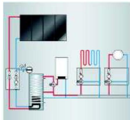
Instalacja solarna do podgrzewu ciepłej wody użytkowej i wspomagania ogrzewania pomieszczeń
