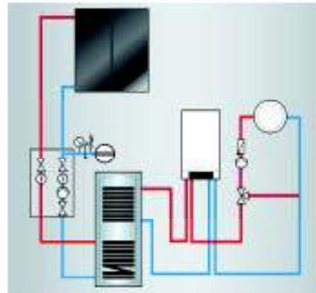
Instalacja solarna do podgrzewu ciepłej wody użytkowej
